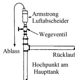
Fig 2-2. Installation des automatischen Luftabscheiders am Hochpunkt des Systems
