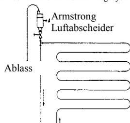
Fig 2-4. Installation des automatischen Luftabscheiders an einer Wendel
