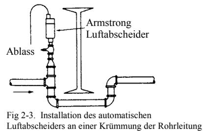
Fig 2-3. Installation des automatischen Luftabscheiders an einer Krümmung der Rohrleitung
