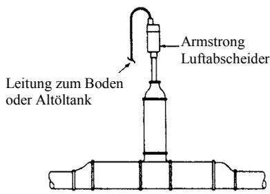
Fig 2-1. Installation des automatischen Luftabscheiders im Rohrleitungssystem
