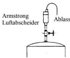
Fig 2-5. Installation an einem Lager oder Sammeltank.
