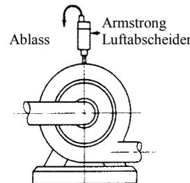
Fig 2-6. Entlüftung an einer Zentrifugalpumpe.
